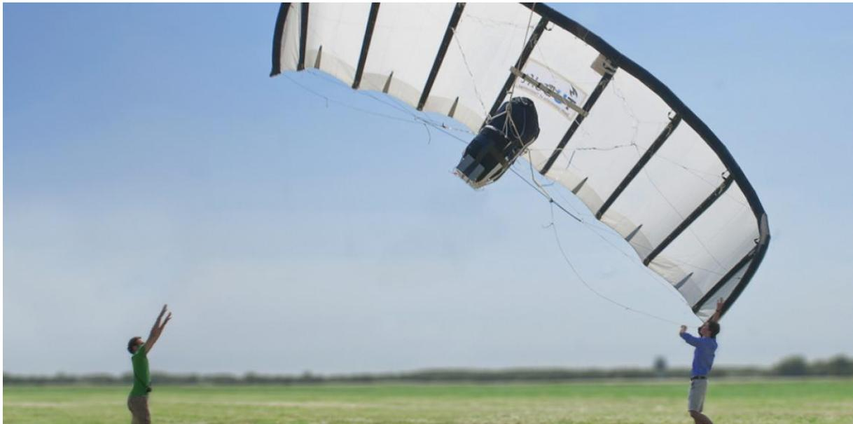
Abbildung 18: Drachen TU Delft mit Steuereinheit<sup>20</sup>
